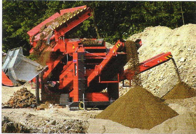
Figura 2.- Equipo de clasificación Resta TK6 con superficie cribante 900x220 mm.
