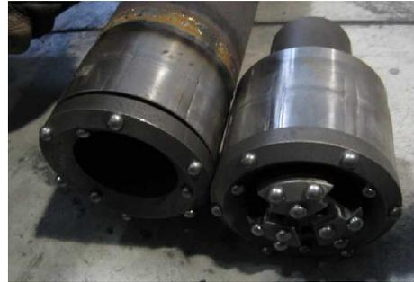
*El empleo de paraguas de micropilotes que trabajan a flexión por empotramiento en el terreno mas allá del frente de excavación, utilizando una serie de tubos colocados mediante perforación y que posteriormente se rellenaran con lechada de cemento, permiten realizar emboquilles en terrenos no consolidados así como atravesar terrenos fallados, permitiendo realizar los trabajos de excavación en condiciones de seguridad.*
